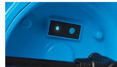
Presione y mantega presionado el **Botón de conexión** en la parte inferior del **Transmisor del tanque** hasta que el LED se ilumine de color azul durante dos segundos, seguido de dos destellos cortos blancos.
