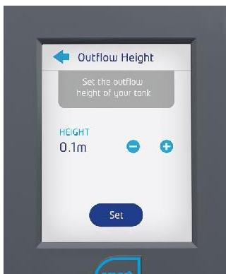
Configure la [Altura de Salida](#), que es la altura desde la cual se drena el agua de su tanque, normalmente alrededor de 0.1 metros.
