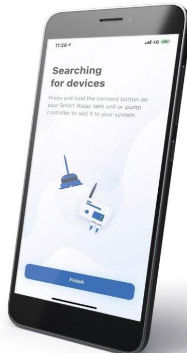
Presione y mantenga el **Botón de conexión** en la parte inferior del **Transmisor del tanque** hasta que el LED se ilumine de color azul durante dos segundos, seguido de dos destellos cortos blancos. La aplicación **Smart Water** monstrará un ícono de tanque y un mensaje una vez que se haya añadido con éxito.
